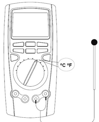
Рисунок 3-8. Измерение температуры
