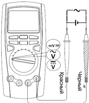
Рисунок 3-1. Измерение напряжения
