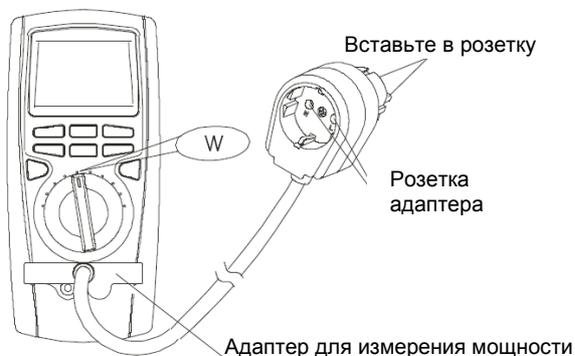
Рисунок 3-9. Измерение мощности
