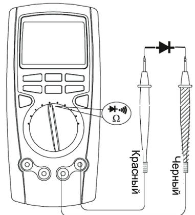
Рисунок 3-5. Проверка диодов
